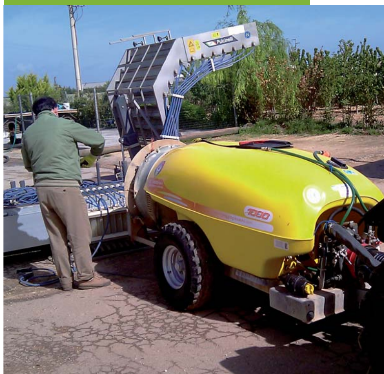
La taratura delle macchine per i trattamenti fitosanitari rappresenta una delle fasi della certificazione
